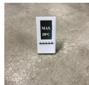
Vloertemperatuur meten bij opstookprotocol
