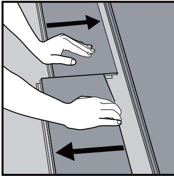
Separe toda la fila levantándola con delicadeza en un ángulo. Para separar los tablones, colóquelos en el suelo y sepárelos. Si los tablones no se separan fácilmente, puede levantarlos ligeramente a unos 5 grados cuando los esté separando.
