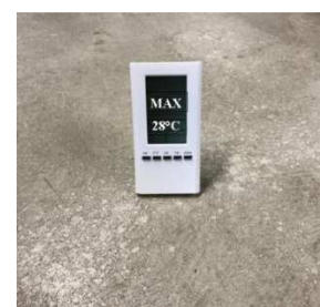
Vloertemperatuur meten bij opstookprotocol
